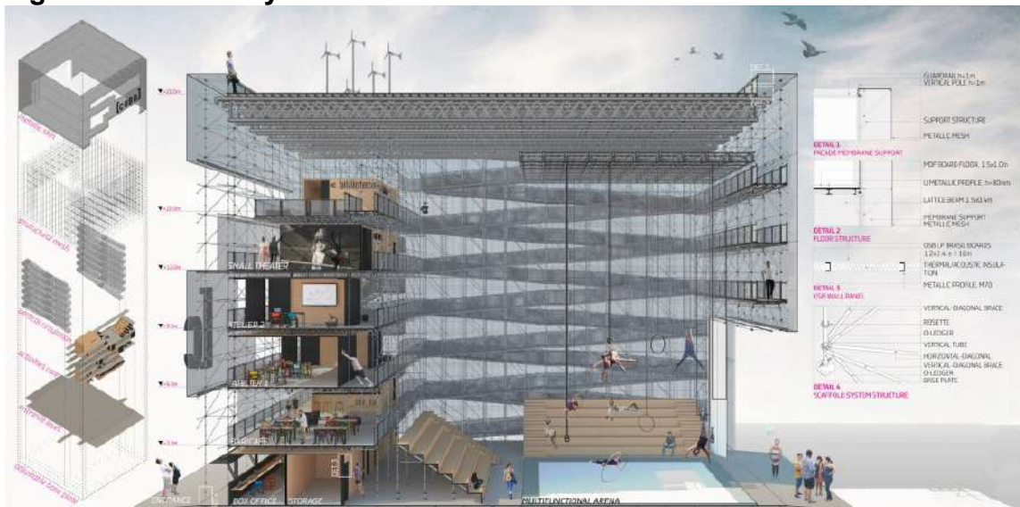
Figura 28. Sección y detalles.
